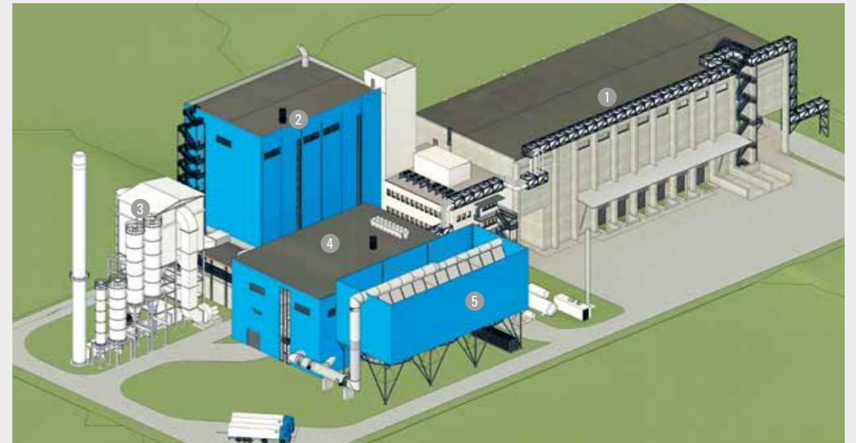
1 Brennstofflager mit Abluftreinigung, 2 Rostfeuerung mit Dampferzeuger, 3 abwasserfreie Rauchgasreinigung, 4 Wasser-Dampf-System mit Turbine, 5 Luftkondensator
